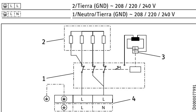
1 PCI de potencia con interruptor de seguridad integral
