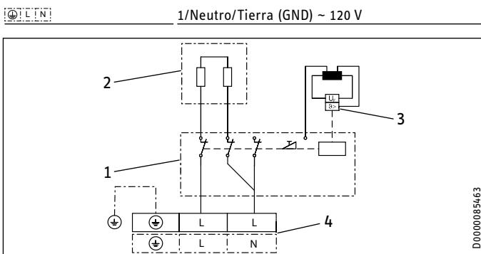
1 PCI de potencia con interruptor de seguridad integral
