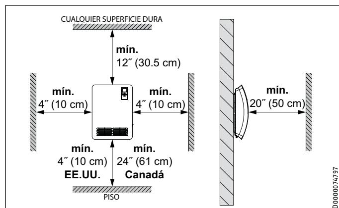
► La imagen de arriba muestra las distancias mínimas permitidas entre el aparato instalado y cualquier superficie dura.
