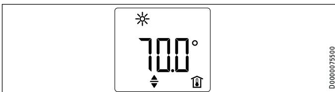
L'écran normal est affiché continuellement. Si aucune saisie utilisateur n'est détectée pendant 20 secondes lorsqu'il est dans le menu, l'appareil passe directement à l'affichage normal.
